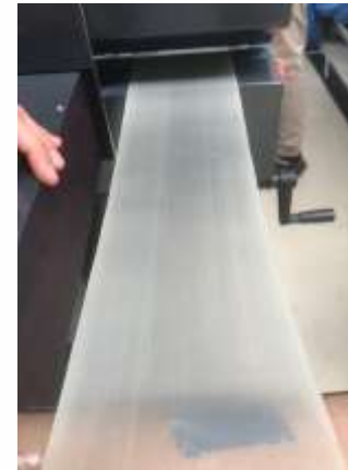
Folienherstellung mit 20% Polybutylensuccinat (PBS)
