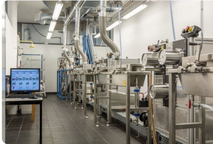
Lösungsmittelnassspinnanlage (Fa. Fourné)
